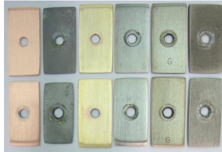
Bild 2: Metallprüfkörper nach ASTM D 1384 (336 h bei 88 °C, 6 l/h Luft) Antifrogen® N/ASTM-Wasser (1:2 v/v)
