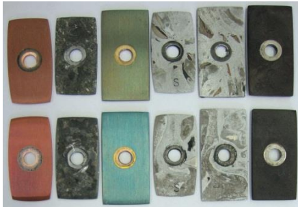
Bild 1: Metallprüfkörper nach ASTM D 1384 (336 h bei 88 °C, 6 l/h Luft) Monoethylenglykol (MEG) ohne Inhibitoren/ ASTM-Wasser (1:2 v/v)
